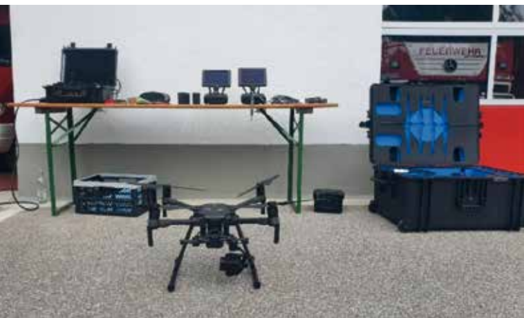
Die Z30 Zoomkamera mit Ausrüstung inclusive Schnellladekoffer und zwei Fernsteuerungen mit Monitor.
